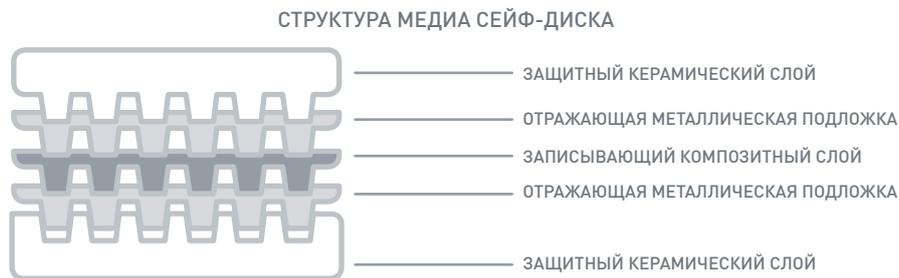
Свойства используемых металлокерамических материалов совместно с технологией многопозиционного плазменного напыления обеспечивают неизменяющийся со временем размер «единиц информации», которые невозможно стереть или переписать.
